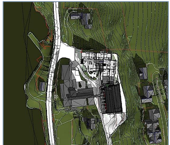
Figur 10: Sol/skygge situasjon kl 12 i september ved etablering av nytt bygg (iVest Consult AS).
