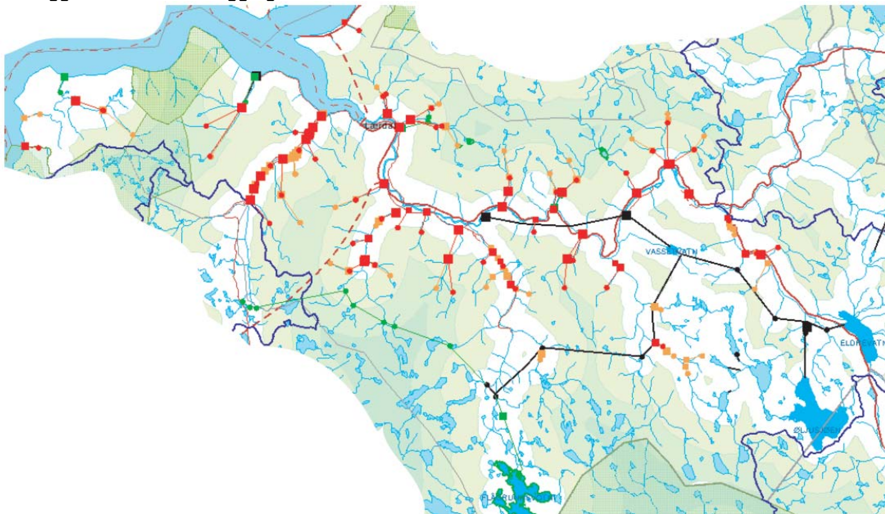
Figur 4: NVE si kartlegging av potensialet for små kraftverk i Noreg. Raud farge er prosjekt til under 3 kr/kWh, mens orange farge er prosjekt mellom 3-5 kr/kWh. Grøn farge er prosjekt som er handsama i forhold til Samla Plan (alle kraftverksprosjekt måtte avklarast mot Samla Plan før 2004). Svart farge er eksisterande kraftverk. Blått er grensa til verna vassdrag.
